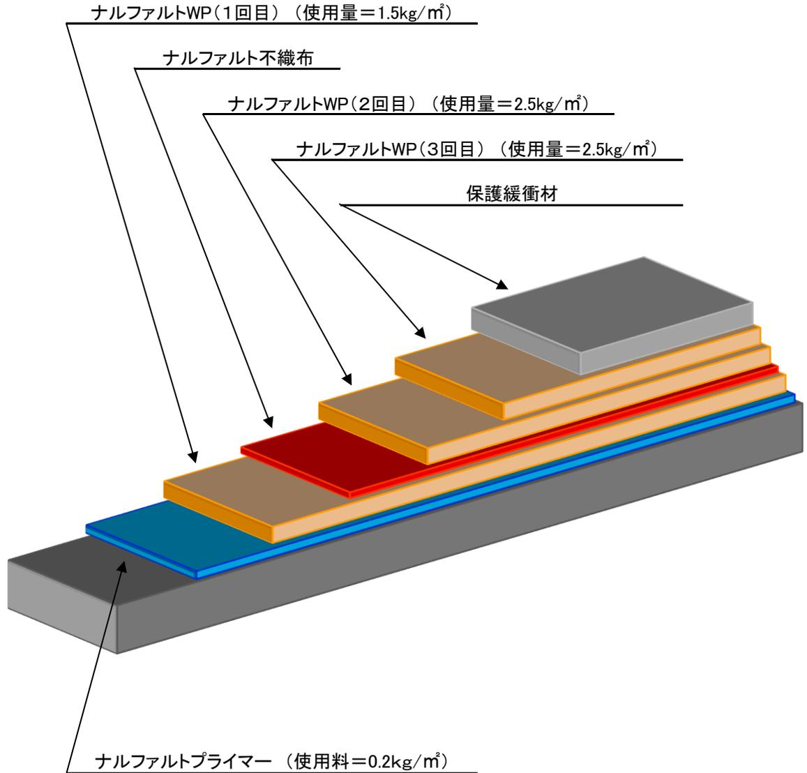
ナルファルト塗膜シート地下外壁密着工法 NPG-Y01-PM工法
