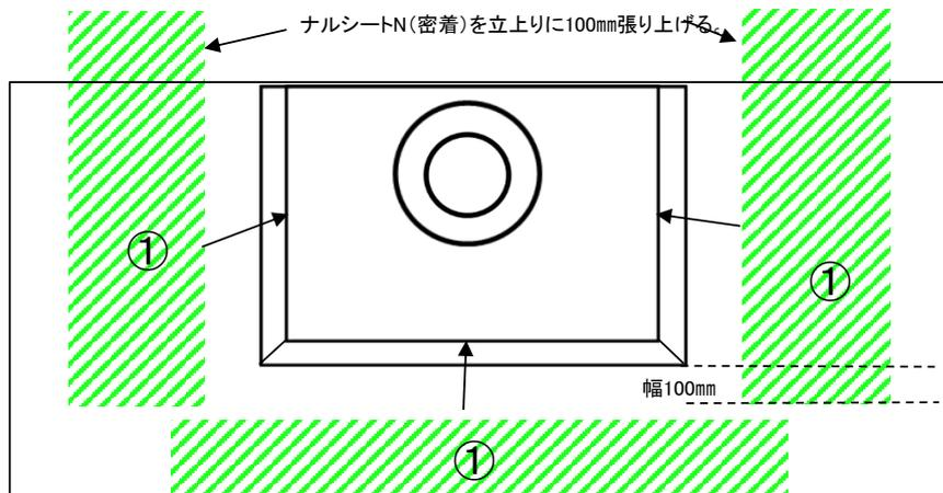
増し張り用ナルシートN(密着)①3枚は断熱材端部に張り付ける。ナルシートN(密着)①同士は突き合わせる。コーナー部は100mmずつ重ねる。
