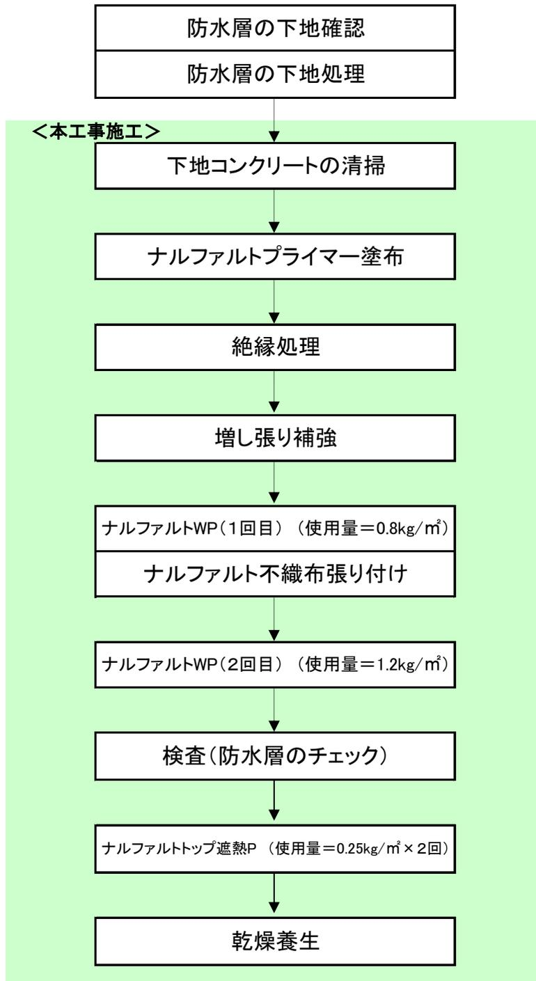
ナルファルト塗膜シート非歩行露出絶縁(遮熱・非歩行)工法 NWW-X01-SP工法
